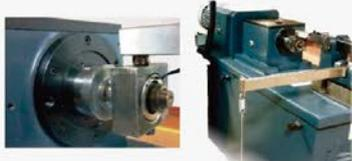
高速低载试验机 (40KN)
