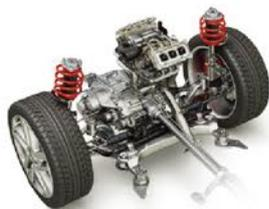
动力系统、变速箱、分动器、差速器、双质量飞轮、制动器、防抱死系统、传动轴、车轴、减震器导向套、悬架
