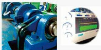
摩擦磨损试验机 (10KN)
