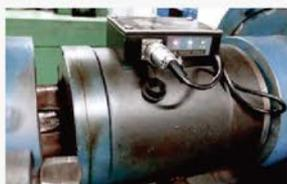
摇摆摩擦磨损试验机 (615KN)
